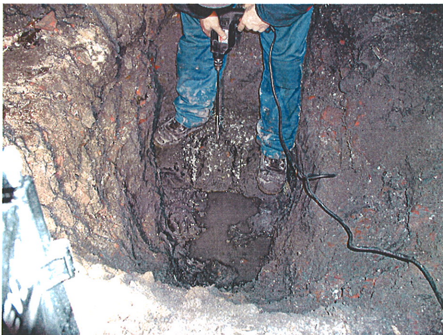
Bilde 1: Tømmerflåte. Friskt trevirke ifølge boring gjennom øvre tømmerlag.
