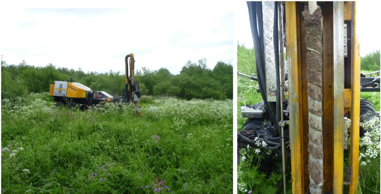
Figur 2.1: Fjernstyrt borerigg og skovl brukt til prøvetaking. Bildet er tatt ved prøvepunkt SK5.
