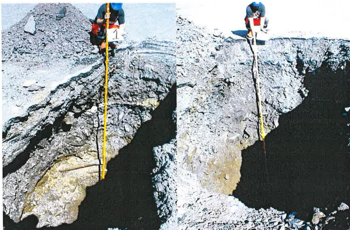
Lokalitet 043 O Bensinteknisk anlegg Sjakt O 1, O 2 og O 3, samt overgang knust stein/sand med slagg ca 4 m UT i sjakt 3.
