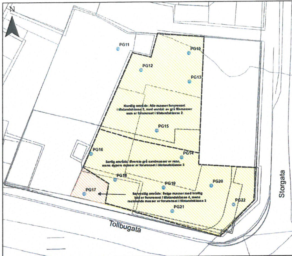
Figur 2. Kart som viser angivelse av forurensningsgrad av massene på den vestre delen av eiendommen. Høyeste forurensningsgrad på det gul-skraverte området er tilstandsklasse 3, mens det ble påvist forurensning i tilstandsklasse 4 på området som er skravert med oransje. PG11-PG22 angir prøvegroppene som ble gravd før oppstarten av gravearbeidene.
