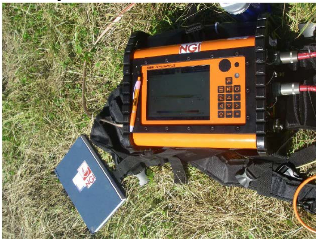
Figur 1: Terrameter LS opptaksenhet posisjonert mellom to kabler. Instrumentet er drevet av et eksternt batteri. Den gjør det mulig i sanntid å plote resistivetsverdier.
