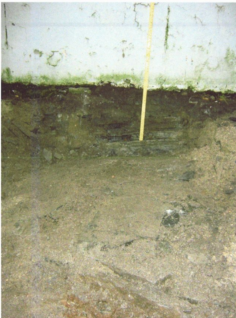
Figur 1: PG1, i krysset mellom Rådhusmauet og Christiesgate. Under den hvitmalte muren ligger det ca. 0,2 m skifer over antatt berg. Like utenfor forkanten av bildet er det sprengt ned en ledningsgrøft i antatt berg.
